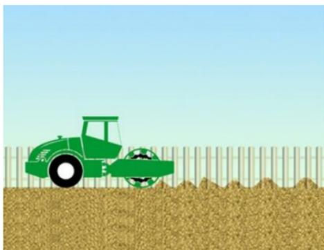
**①** 如果基础是松软的泥土，最好在施工前将其压实，以免雨水浸泡后出现泥水渗出等问题。
