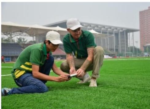
使用人造草专用检测工具“填充高度尺”测量石英砂和胶粒的填充高度是否合适。
